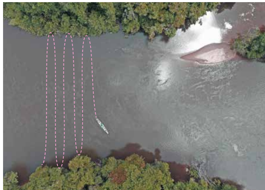
Exemple de protocole d'échantillonnage basé sur un transect de prélèvement d'eau de berge à berge sur le Maroni, en Guyane.
